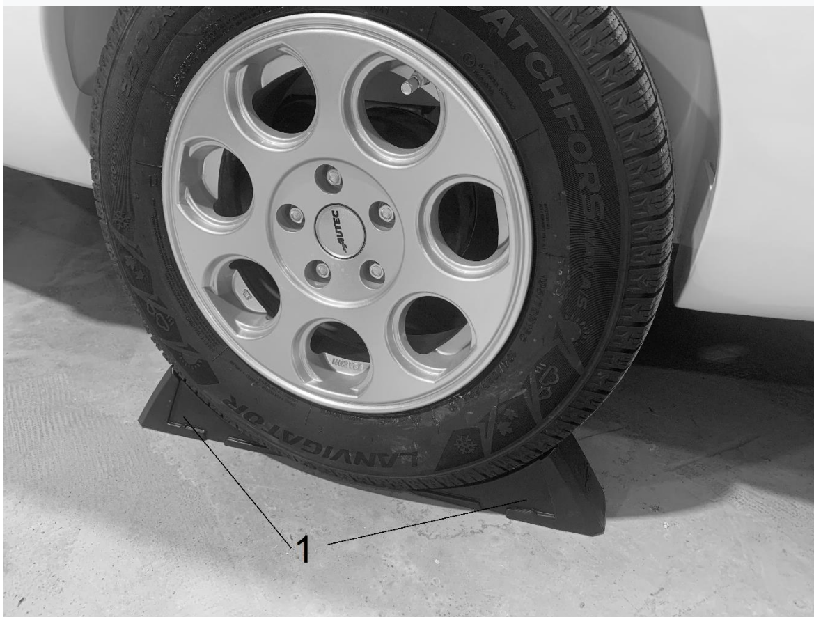
Рис.4.15 – Протівідкатні упори підставлені під колесо (1 – протівідкатні упори)
