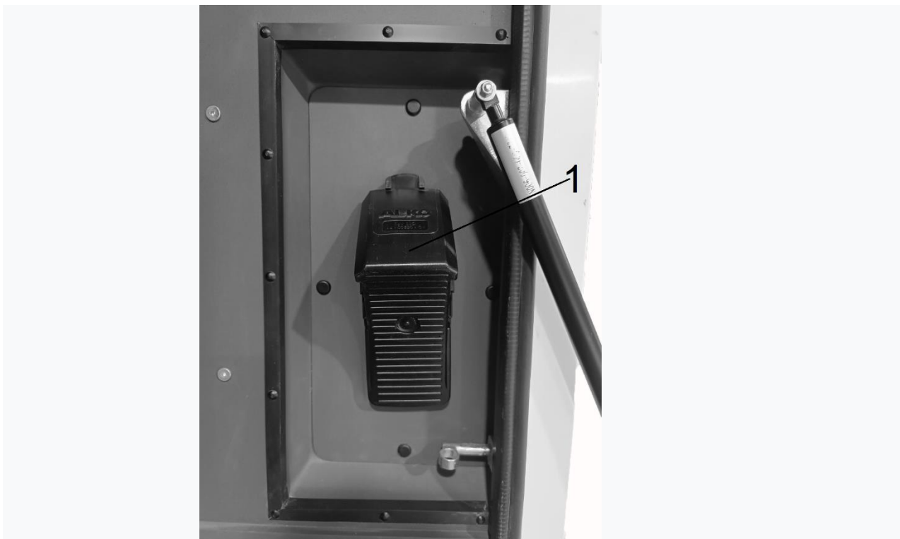
Рис.4.14 – Протівідкатний упор (1 – протівідкатний упор)
