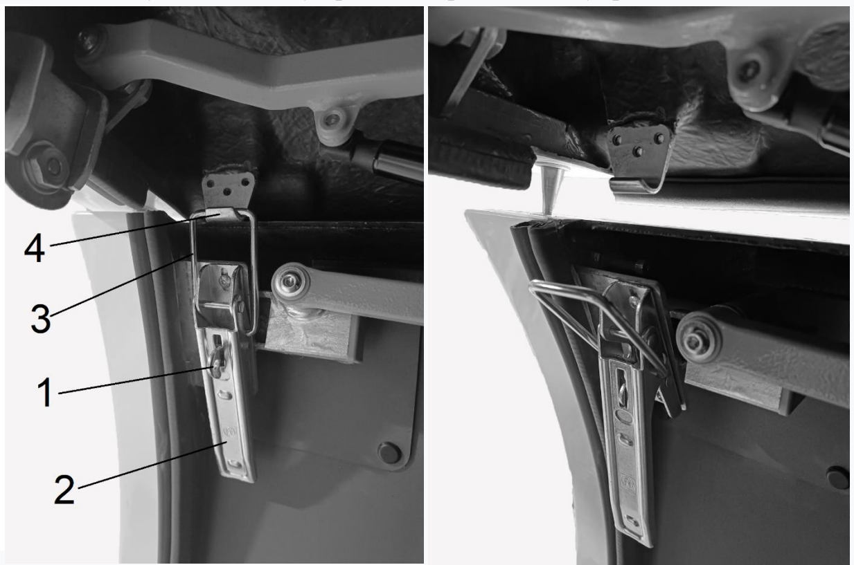
Рис.4.10 – Замок даху (1- захисний важіль, 2 – запірний механізм, 3 – скоба, 4 – крюк)
